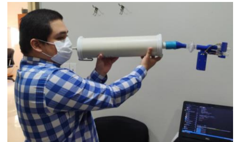
Fig 2 Pruebas de calibración del EDI con la jeringa estándar de 3 litros
