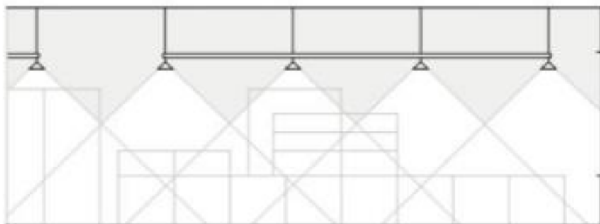
Figura 125: Tipo de luminaria en una estructura luminosa suspendida. Fuente: Tomado del Libro, Como Planificar con Luz (Ganslandt y Hofman 2009)
