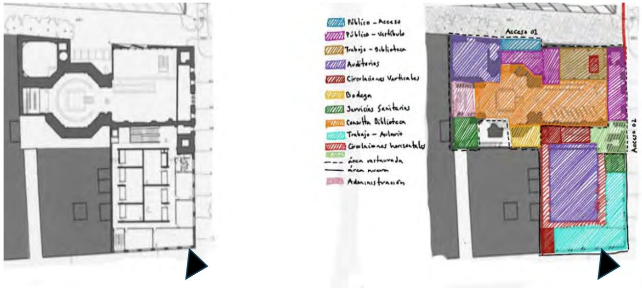
Figura 97 Planta original y planta de proyecto Esquema de funciones del espacio. Fuente: Edición propia de la autora.
