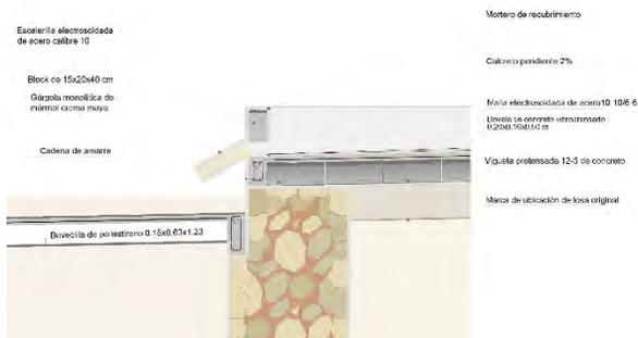
Figura 128 Detalle de intervención de losa de dovela. Fuente: imagen propia de la autora.
