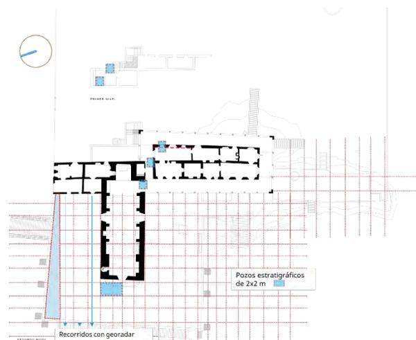
Figura 114 Planta esquema para recorrido de georadar y pozos
