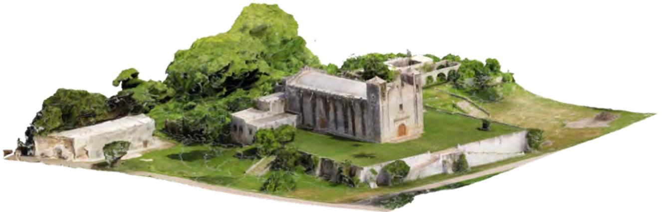
Figura 53 Volumetría generada por nube de puntos a partir de un vuelo programado de drone. Fuente: Arqueodron® septiembre 2019.
