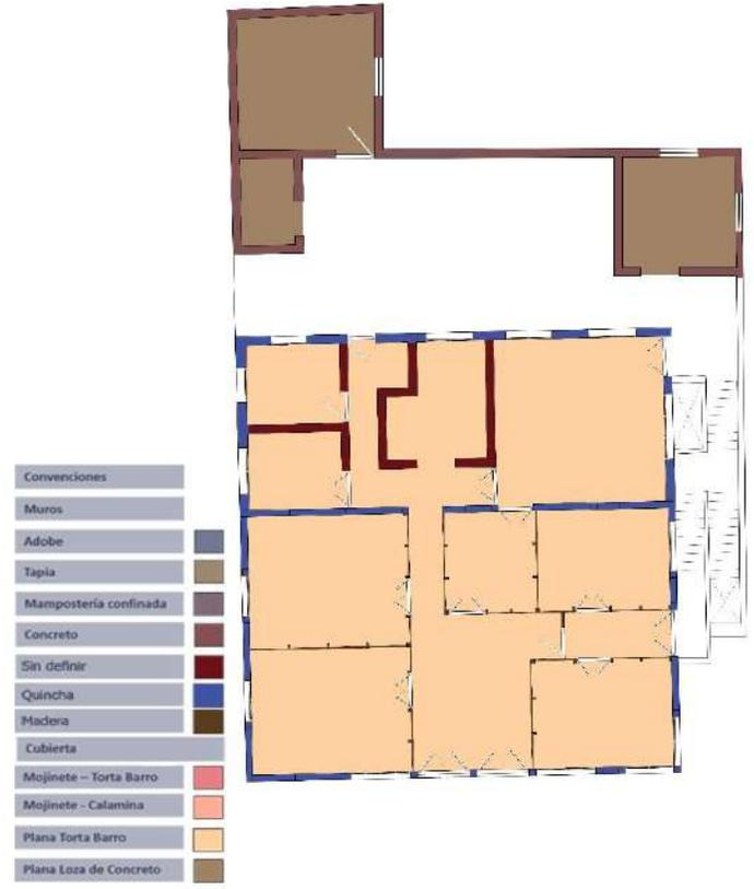
Ilustración 54 Sistemas Constructivos Segundo Nivel Fuente: Elaboración Efran Ventura
