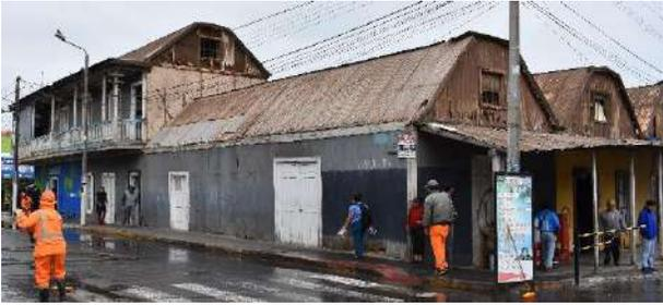
*Ilustración 37 Conjunto Gambeta Ejemplo de Tipología Mojinete Trunco en la Republica Estructura en Madera y Cubierta en Calamina Fuente: Propia*
