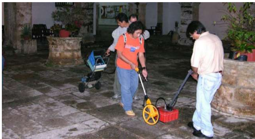
Fig. 4.7 Prospección geofísica realizada en una sección del patio claustral.
