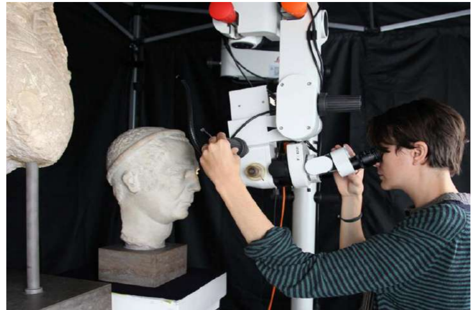
Con la ayuda de un microscopio estereoscópico combinado con un estativo de suelo, se documentan rastros de color en un retrato en mármol griego
