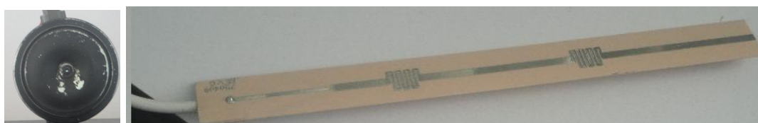
Figura 9: Bocina de auto adicionada al tablero y la antena de Bluetooth.
