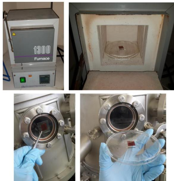
**Figura 4.4.** Tratamiento térmico posterior al depósito, Laboratorio de materiales, FIUADY.
