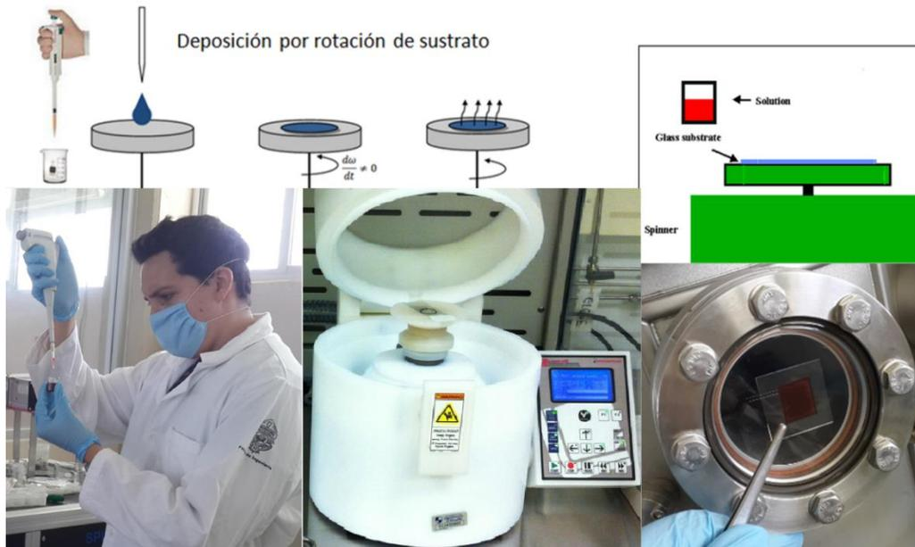
**Figura 4.3.** Depósito por rotación de sustrato, Laboratorio de materiales, FIUADY.
