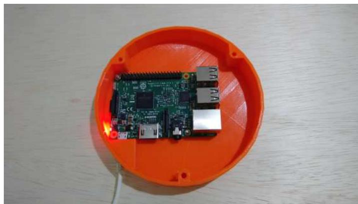
Figura 5-4: Representación real del prototipo (base).
