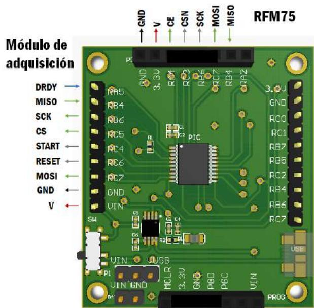
Figura 4.6: Cara superior de la tarjeta que contiene el microcontrolador PIC16LF1829. Se muestran las conexiones realizadas correspondientes al ADS1298/99 y al transceptor RFM75.
