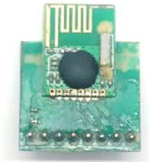
Figura 4.7: Módulo del transceptor de radiofrecuencia RFM75.
