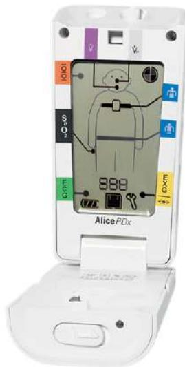
Figura 4.13: Dispositivo para polisomnografía Alice PDx de la empresa Philips.
