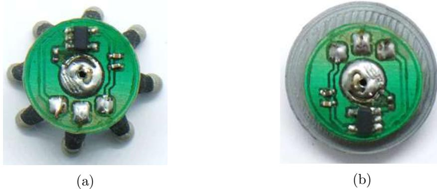
Figura 5.10: Se muestran los electrodos activos para a) EEG y b) EMG y EOG con la tarjeta desarrollada que se coloca sobre cada electrodo.
