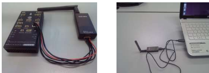
(a) Conexión de telemetría al HK32pilot. (b) Conexión de telemetría a la estación de control.
