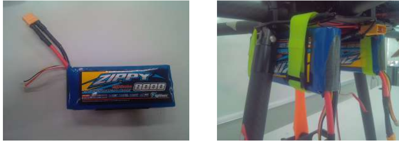
Figura 3.12: Baterías LiPo montadas en el vehículo.
