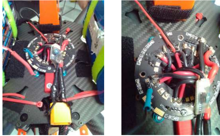
Figura 3.16: Montaje de la PDB en el cubierta.
