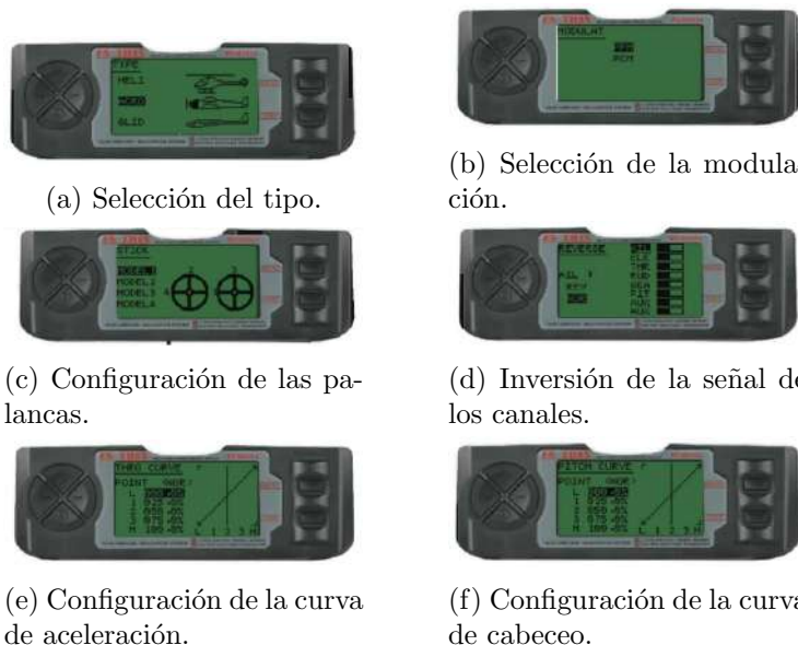
Figura 3.20: Configuraciones realizadas en el control remoto FS-TH9X.
