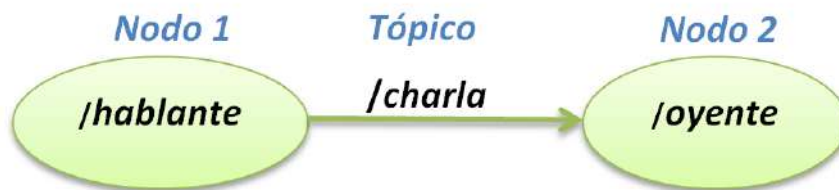
Figura 3.45: Comunicación entre Nodos.
