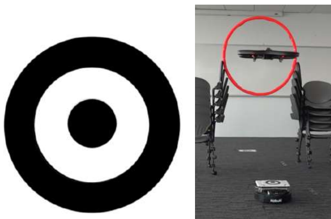
Figura 2.2: Implementación de Visual Servoing en un AR.Drone para la detección de un marcador.
