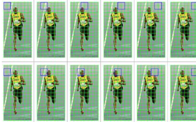
Figura 3.15: Normalización llevada a cabo desplazando los bloques de 16x16
