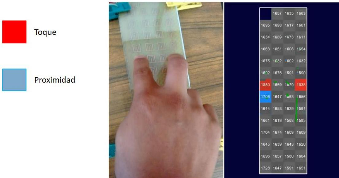
Figura 66: Prueba de funcionamiento de los sensores del brazo mediante una mano
