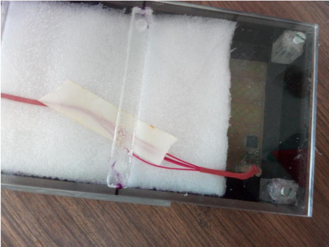
*Figura 68: Vista inferior del laberinto ilustrando el foam, la varilla transversal y las varillas para sujetar la tapa.*
