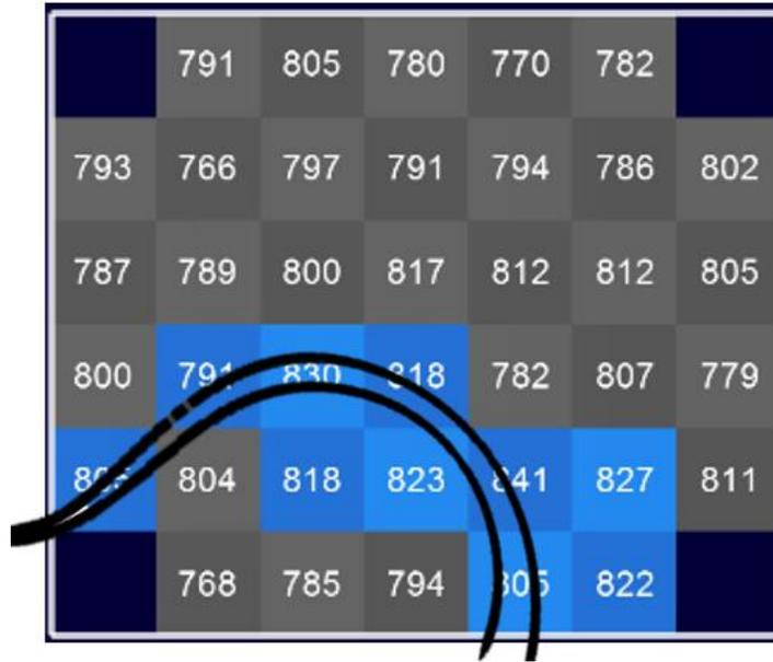
Figura 63: Activación de los sensores de la zona central por la cola de la rata
