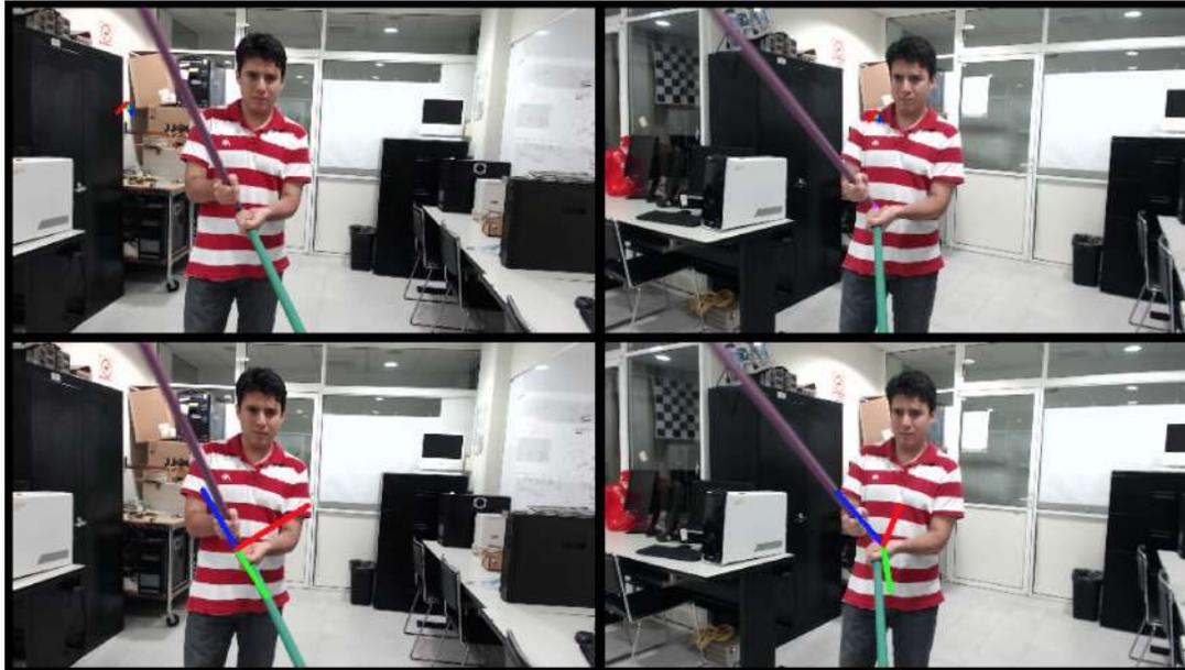
Figura 33: Sistema funcionando en condiciones de paralelismo en la cámara izquierda, arriba el sistema sin filtro de Kalman, abajo el sistema funcionando con la estimación del movimiento.
