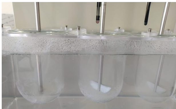
Figura 19. Prueba disolución de la tableta, los medios presentan turbidez y polvos en suspensión. La disgregación se observó en un periodo menor a tres minutos para las 12 tabletas evaluadas en cada medio. No se observó tendencia a la aglomeración o resistencia a la liberación.
