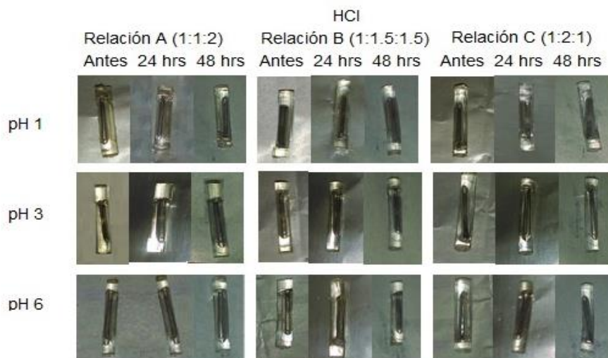
Figura 21. Imágenes de las barras con los recubrimientos PDMS:TEFS:CNPrTEOS asociados a las relaciones A(1:1:2), B(1:1.5:1.5) y C(1:2:1) antes y después de ser expuestas a diferentes condiciones de pH con ácido clorhídrico (HCl) por 24 y 48 h.
