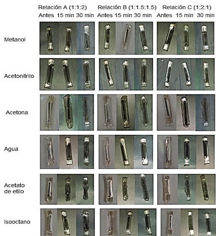
Figura 17. Imágenes de las barras con los recubrimientos PDMS:TEFS:CNPrTEOS asociados a las relaciones A(1:1:2), B(1:1.5:1.5) y C(1:2:1) antes y después de los ensayos de resistencia a disolventes con agitación vórtex durante 15 y 30 minutos.
