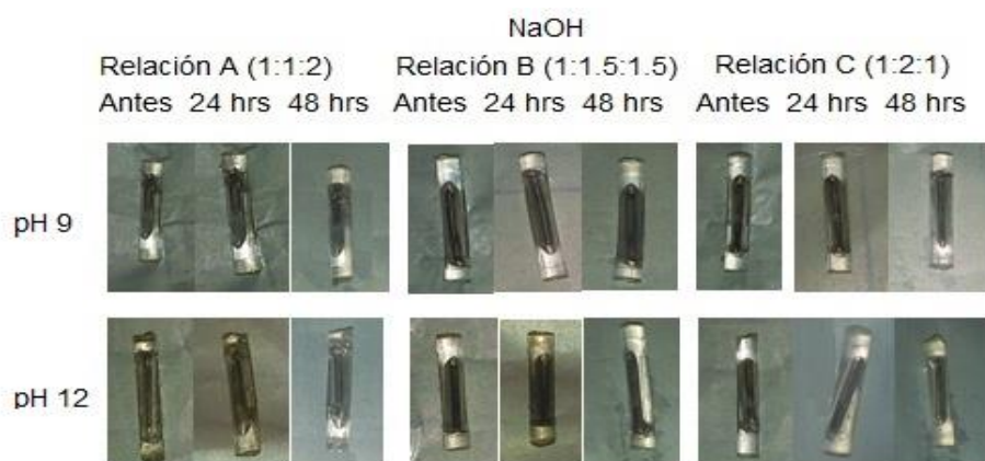
Figura 23. Imágenes de las barras con los recubrimientos PDMS:TEFS:CNPrTEOS asociados a las relaciones A(1:1:2), B(1:1.5:1.5) y C(1:2:1) antes y después de ser expuestas a diferentes condiciones de pH con hidróxido de sodio (NaOH) durante 24 y 48h.
