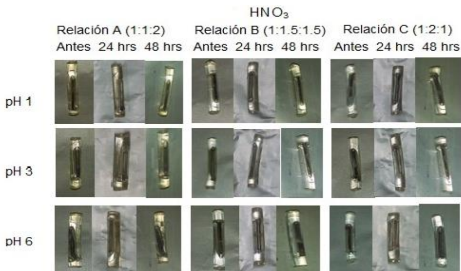
Figura 22. Imágenes de las barras con los recubrimientos PDMS:TEFS:CNPrTEOS asociados a las relaciones A(1:1:2), B(1:1.5:1.5) y C(1:2:1) antes y después de ser expuestas a diferentes condiciones de pH con ácido nítrico (HNO 3 ) durante 24 y 48 h.
