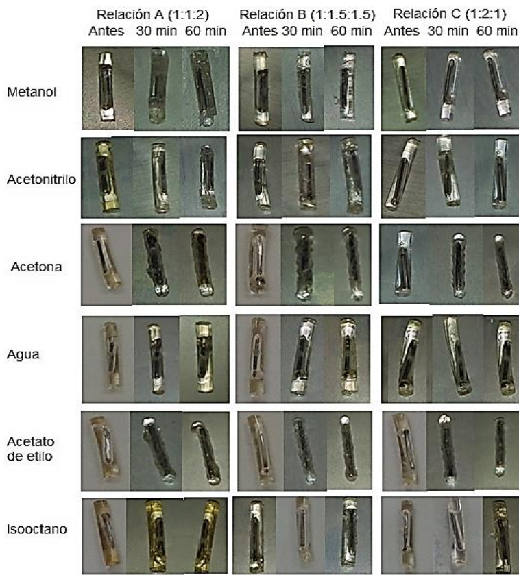
Figura 19. Imágenes de las barras con los recubrimientos PDMS:TEFS:CNPrTEOS asociados a las relaciones A(1:1:2), B(1:1.5:1.5) y C(1:2:1) antes y después de los ensayos de resistencia a disolventes y ultrasonificación durante 30 y 60 min.
