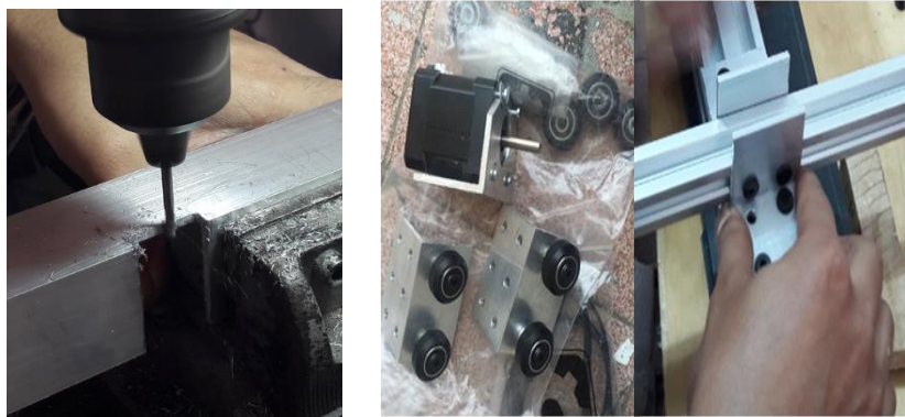
Figura 8. Ensamble de piezas de aluminio y perfiles y ensamble mecánico terminado.
