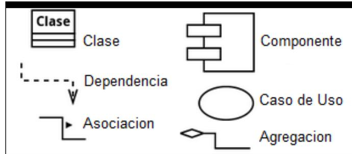
Figura 1. Ejemplos de Notación en UML [1].
