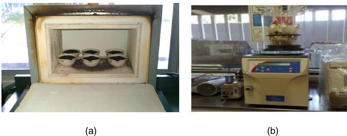
Figura 4.8: (a) Mufla empleada para el tratamiento térmico, (b) liofilizadora empleada
