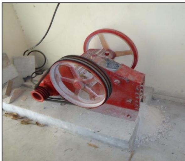
Figura 19. Trituradora portátil de mandíbulas de 4"
