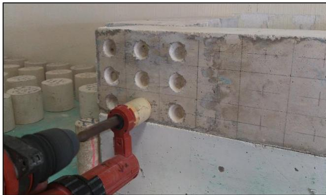
Figura 34. Extracción de polvos de concreto
