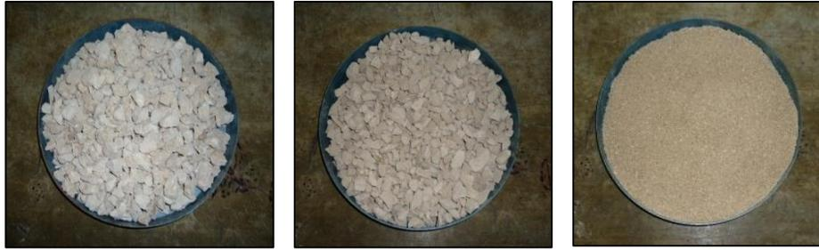
Figura 21a. Grava reciclada. Figura 21b. Grava normal Figura 21c. Agregado fino
