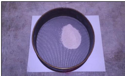
Figura 35. Cribado de polvo de concreto
