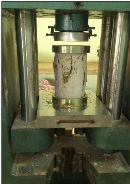
Figura 25. Prueba de resistencia a la compresión
