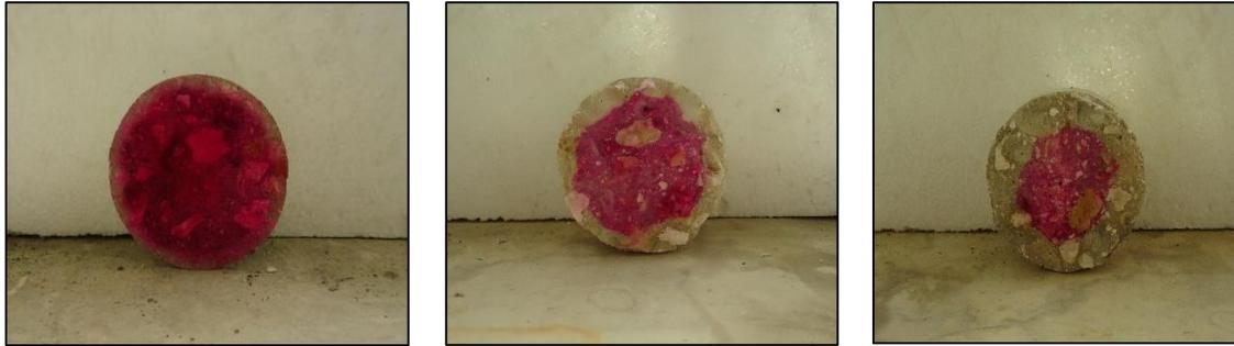
Figura 31. Avance de los frentes de carbonatación en concretos con 0.5 a/c
