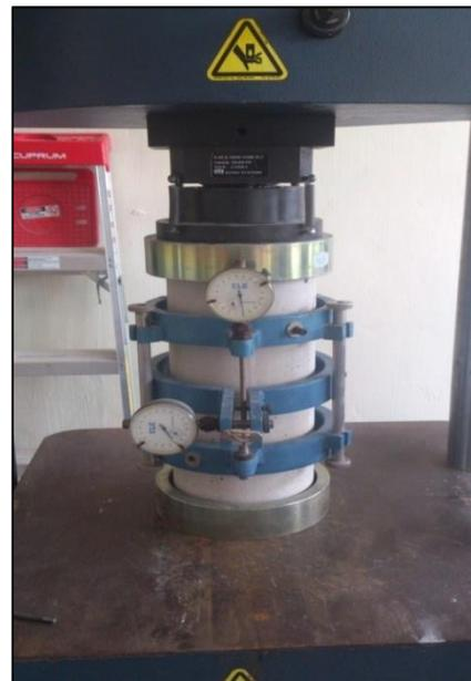
Figura 26. Prueba de módulo de elasticidad
