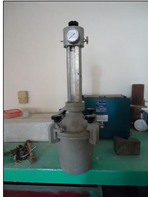
Figura 24. Medidor de aire atrapado tipo A
