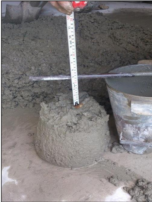
Figura 23. Prueba de revenimiento
