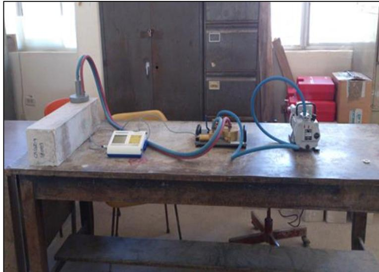
Figura 28. Prueba de permeabilidad al aire en vigas
