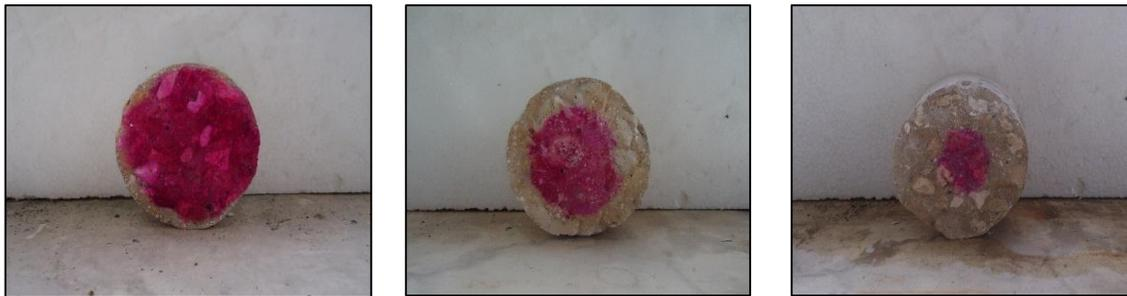
Figura 32. Avance de los frentes de carbonatación en concretos con 0.7 a/c
