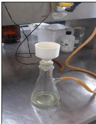
Figura 39. Filtración al vacío
