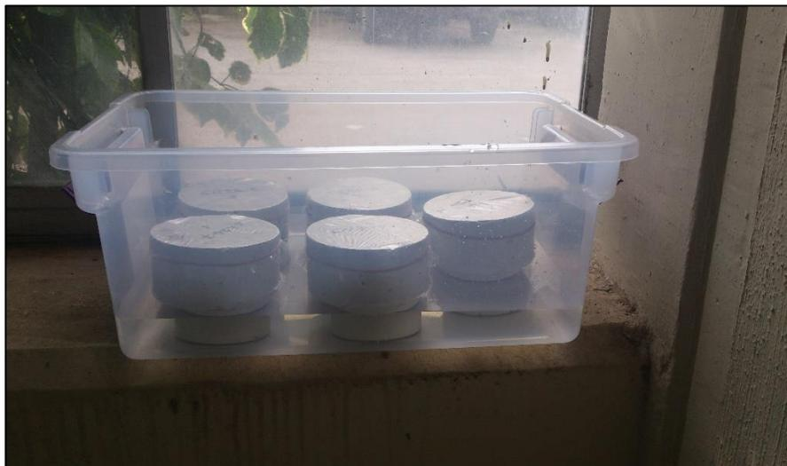
Figura 27. Prueba de absorción capilar
