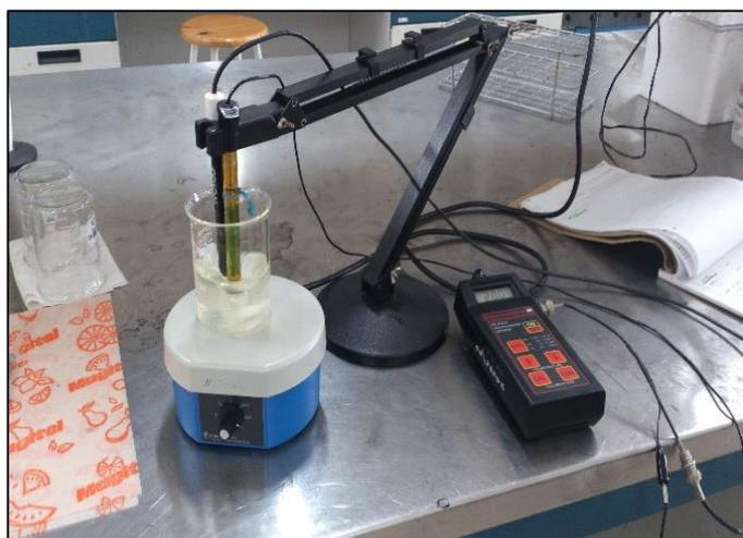
Figura 41. Medición de potenciales electroquímicos
