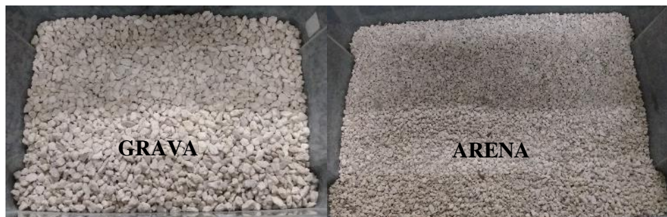
Figura 8: Material de soporte de roca caliza utilizado en los humedales construidos
