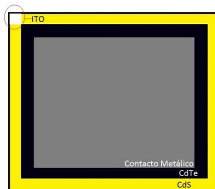
Figura 51 Esquema de máscara para contacto sobre ITO
