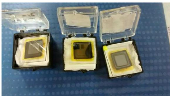
Figura 46 Celdas Solares de CdS/CdTe
