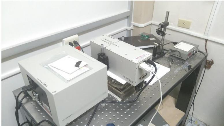
Figura 30 Equipo de Respuesta Espectral
