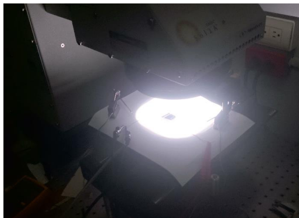
Figura 3.8 Celda en proceso iluminación con potencia de 1 sol.
