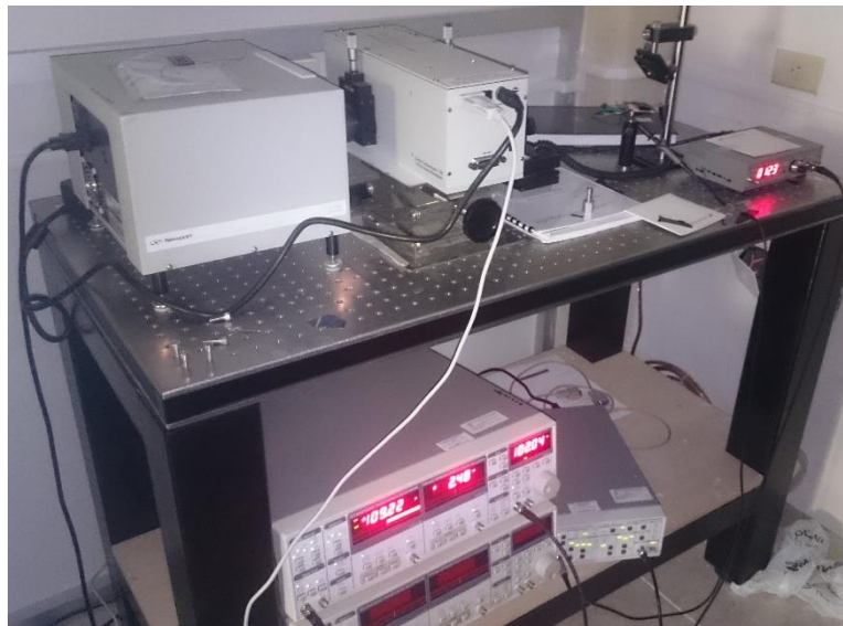
Figura 3.9 Equipo de medición de Respuesta Espectral.
