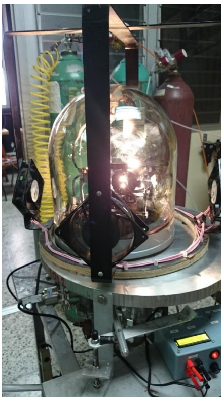
Figura 3.2 Sistema CSS con su campana y extractores de calor en funcionamiento
