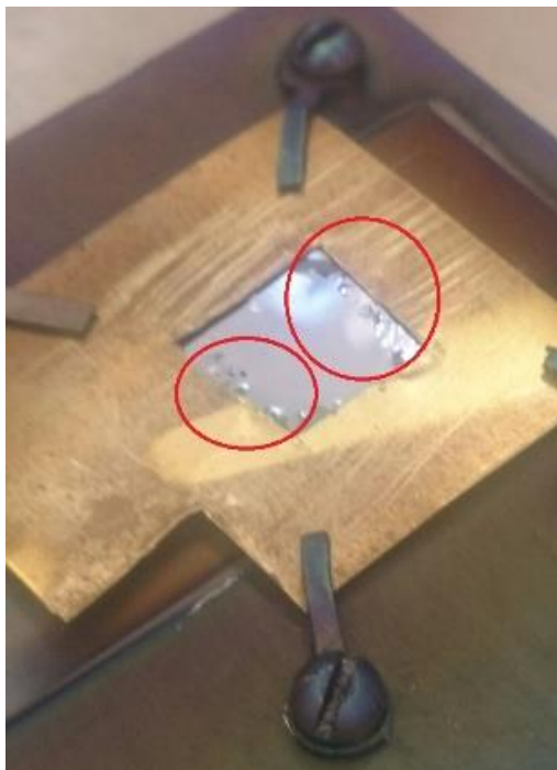
Figura 4.11 Mala adherencia en las capas de las celdas C1 y C2
