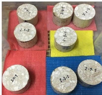
*Figura 3.26 Cilindros cortados a 5 cm de altura.*
