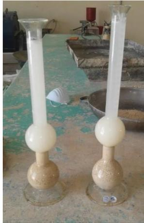
*Figura 3.8 Densidad específica del agregado fino.*
