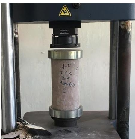
*Figura 3.23 Vista del ensaye de resistencia a compresión axial en cilindros de concreto.*
