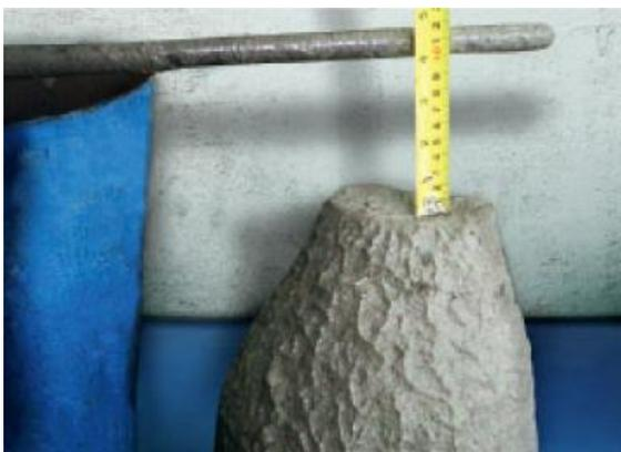
*Figura 3.11 Revenimiento del concreto.*
