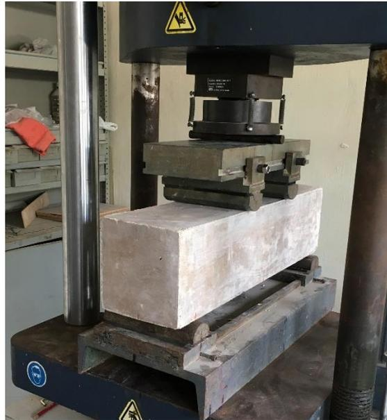
*Figura 3.25 Vista del ensaye de resistencia a tensión por flexión del concreto.*
