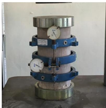
*Figura 3.24 Vista del ensaye del módulo de elasticidad del concreto.*
