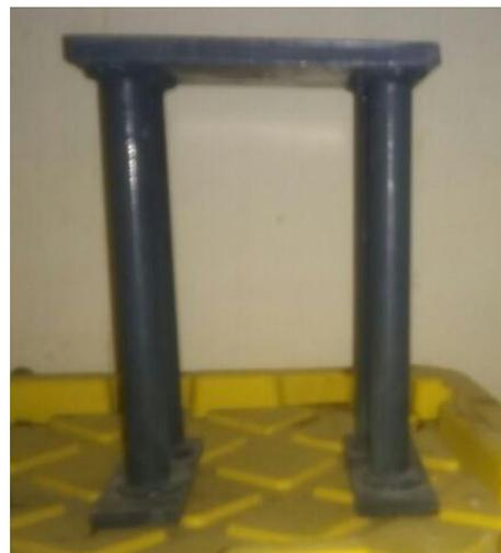
Figura 3.32 Silleta metálica
