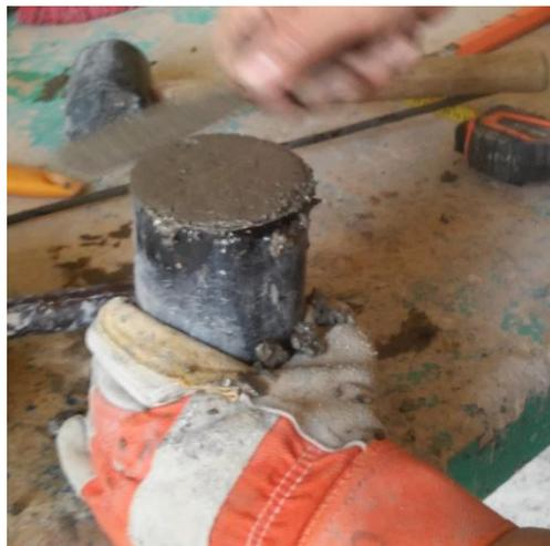
*Figura 3.14 Cilindro de concreto de 7.5 cm de diámetro.*
