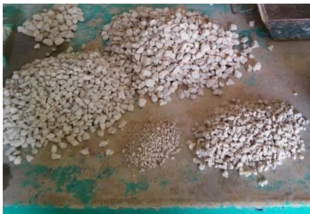
*Figura 3.9 Muestra cribada de agregado grueso.*
