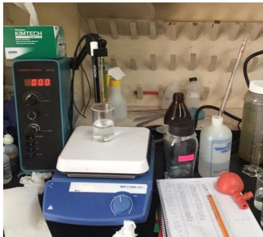
*Figura 3.27 Evaluación de las muestras con el equipo Conductronic.*
