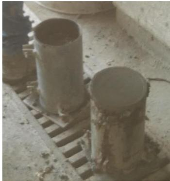
*Figura 3.13 Cilindros de concreto de 15 cm de diámetro.*
