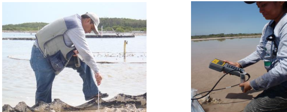
Figura 6. Toma de muestras de agua intersticial y lectura de parámetros físicos.
