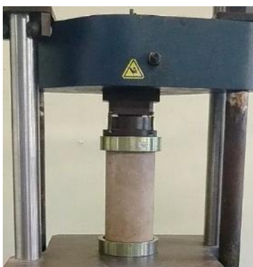
Figura 3.3 Vista del ensaye a compresión axial de un cilindro de concreto.
