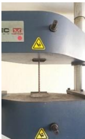
Figura 3.4 Vista del ensaye a tensión de una barra de acero
