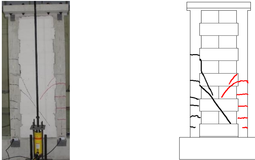
Figura 4.9 Grietas por flexo-cortante en ambos lados del muro Mc4
