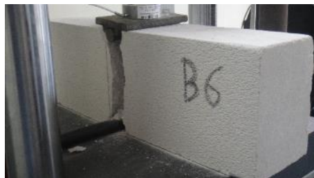
Figura 4.2 Falla típica observada en el bloque de CCA
