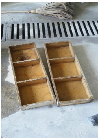
Figura 9.- Moldes para la elaboración de losas de concreto.
