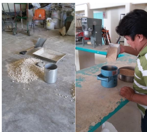
Figura 4.- Prueba de pesos volumétricos.
