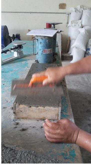
Figura 10.- Elaboración de losas de concreto.
