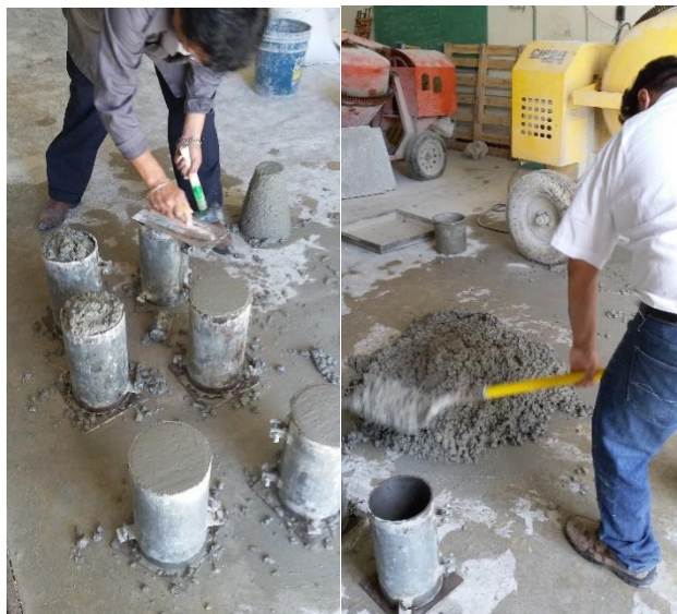
Figura 8.- Elaboración de cilindros de concreto.
