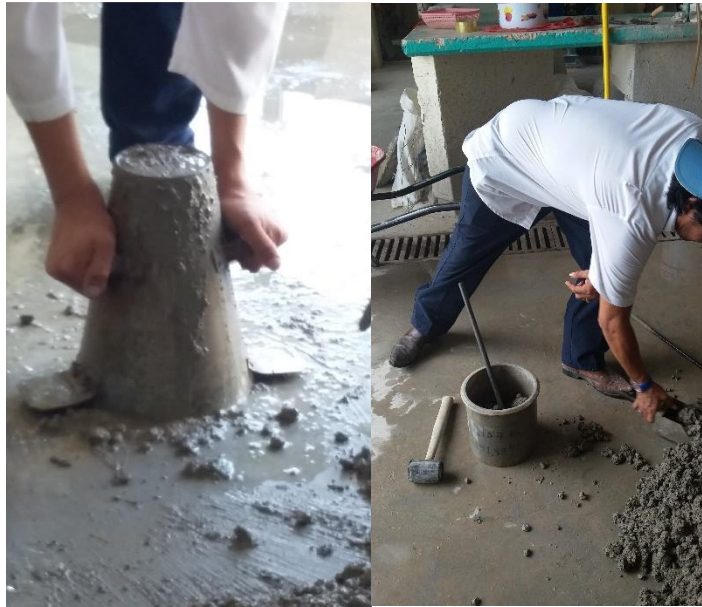
Figura 7.-Pruebas de revenimiento y peso volumétrico al concreto Fresco.
