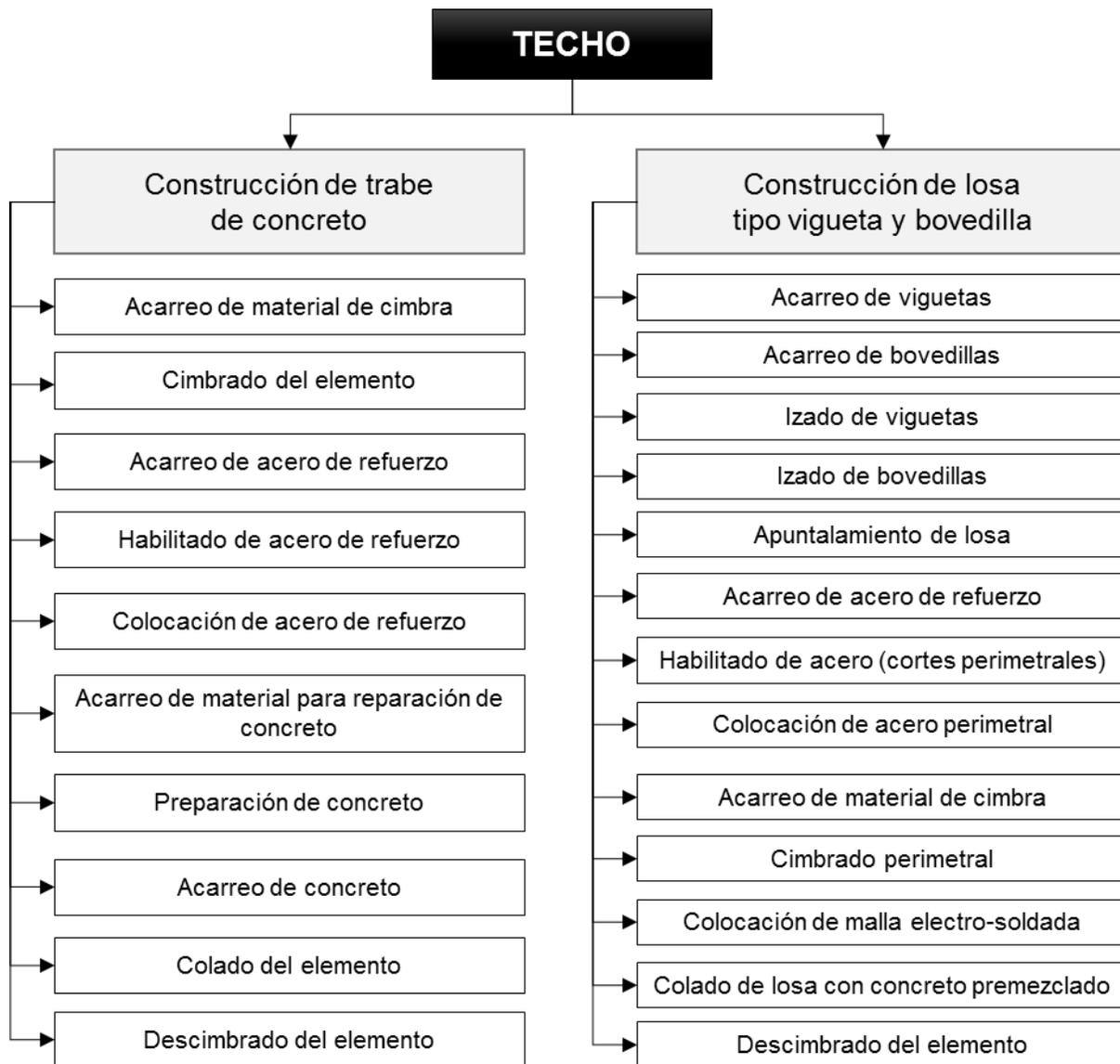
Figura 13. Estructura de desglose del concepto de trabajo de Techo
