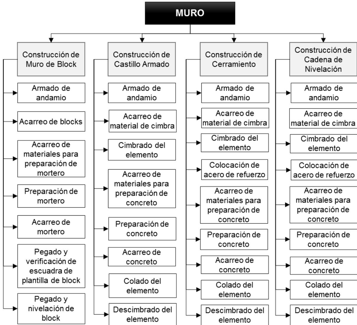
Figura 11. Estructura de desglose del concepto de trabajo de Muro
