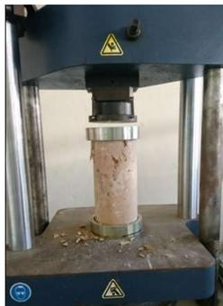
Figura 3.1 Vista del ensaye a compresión axial de un cilindro de concreto
