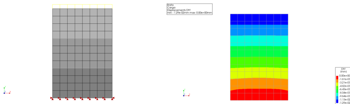
a) Malla de elementos finitos
