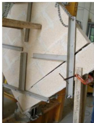
a) Falla por deslizamiento
