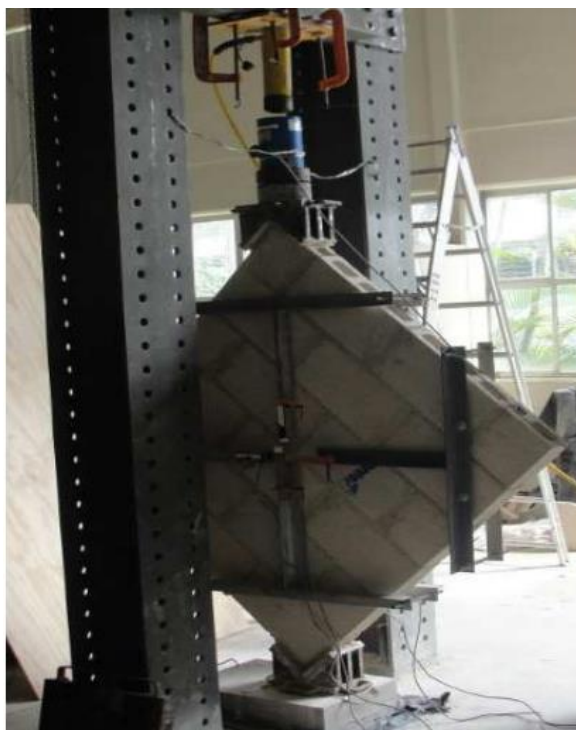
Figura 3.1 Ensayo de muretes de mampostería de acuerdo con la norma NMX-C-464-ONNCCE
