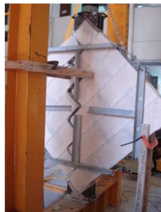
b) Falla por tensión diagonal
