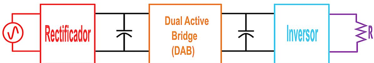
Figura 2.1: Operación Básica de un Transformador de Estado Sólido.
