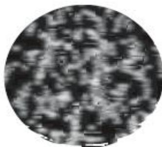
Figura 37 patrón de moteado por la luz dispersada de las partículas (Zetasizer Nano User Manual, 2013).
