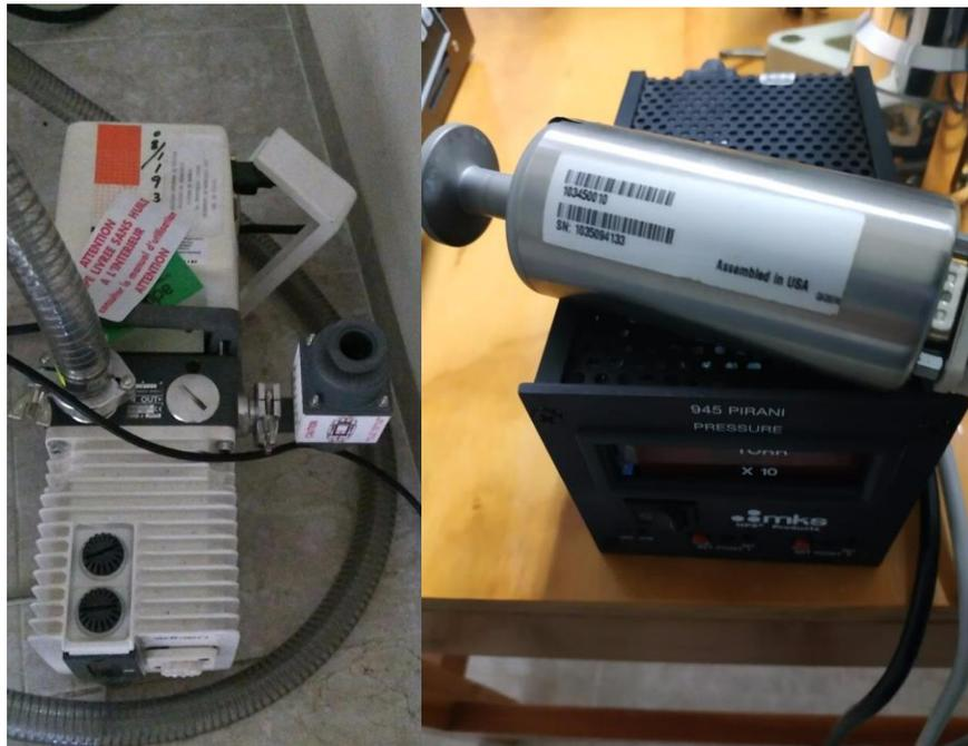
**Figura 3.4** Bomba de vacío y sensor de vacío
