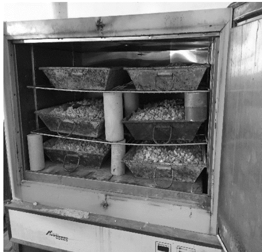
Prueba de absorción de la grava y de la arena
