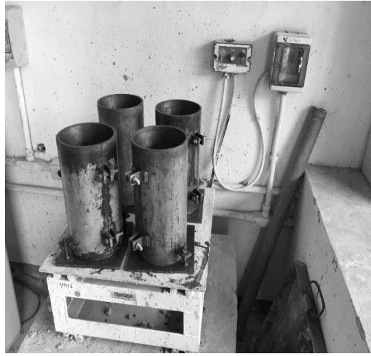
Compactación de especímenes en la mesa de vibrado
