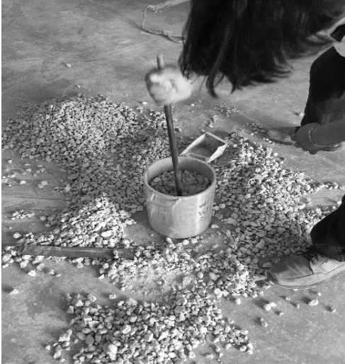
Prueba de peso volumétrico seco compacto de la grava
