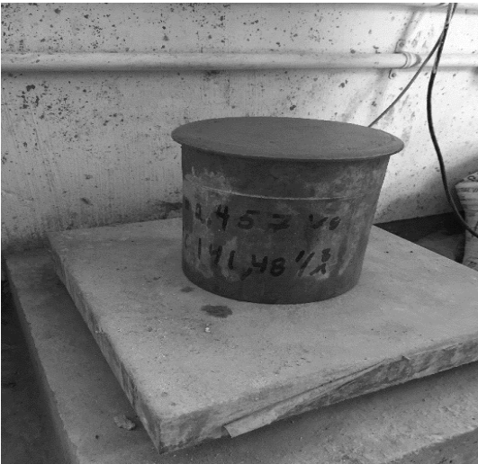
Prueba de peso volumétrico al concreto fresco
