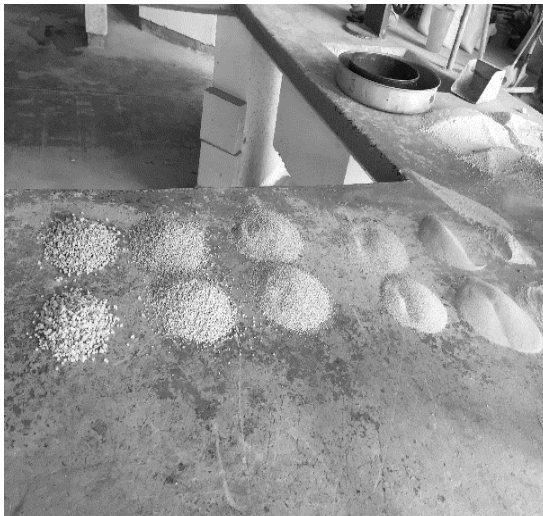
Prueba de granulometría de la arena y su módulo de finura
