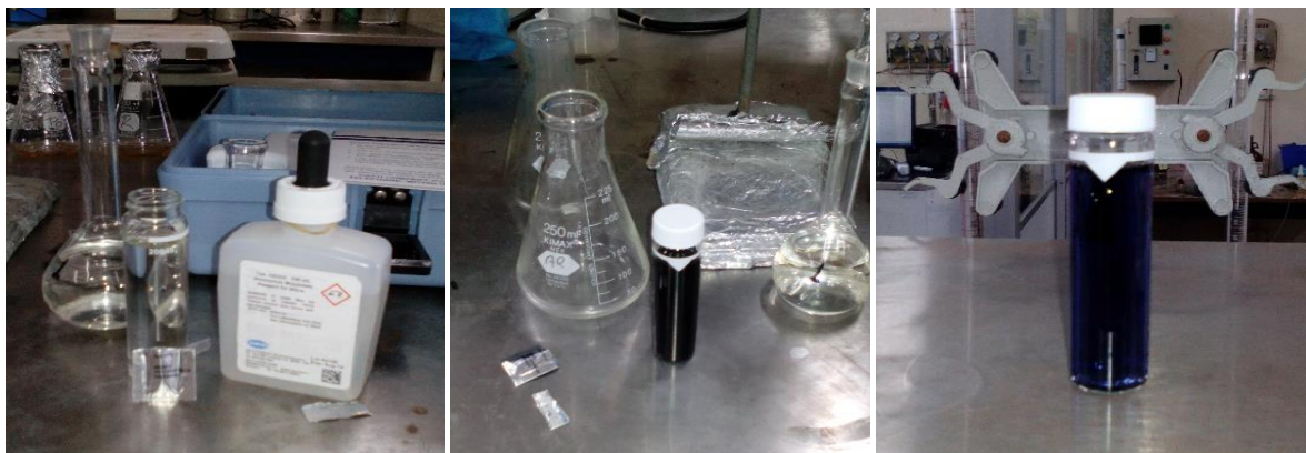
Figura 8. Determinación de peróxido de hidrógeno residual
