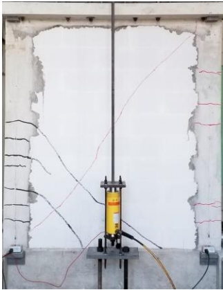
Figura 4.13 Agrietamiento por flexo-cortante del muro M-1.23-3.0.
