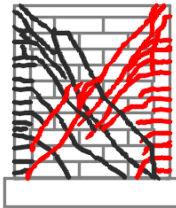
Figura 4.15 Patrón de agrietamiento final del muro M1.23-3.0.
