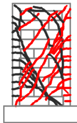
Figura 4.23 Patrón de agrietamiento final del muro M-1.94-3.0.
