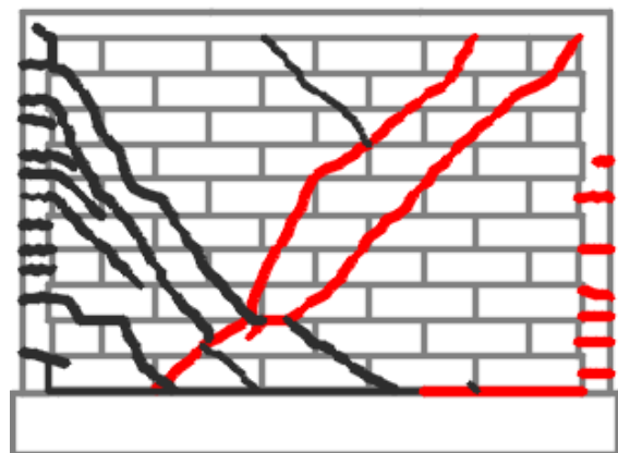
Figura 4.5 Agrietamiento diagonal por cortante del muro M-0.71-3.0.
