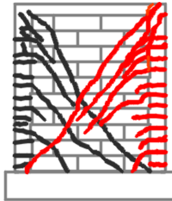
Figura 4.14 Grietas por flexión, flexo-cortante y diagonales por cortante a la carga máxima del muro M-1.23-3.0.
