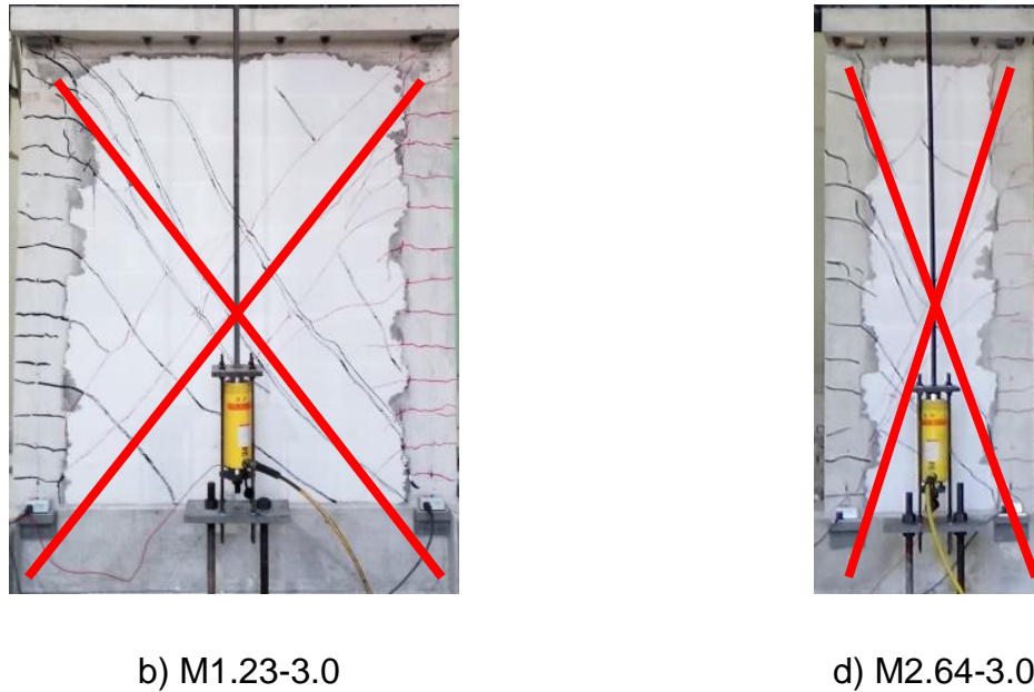
Figura 5.1 Patrón de agrietamiento final en forma de "X".
