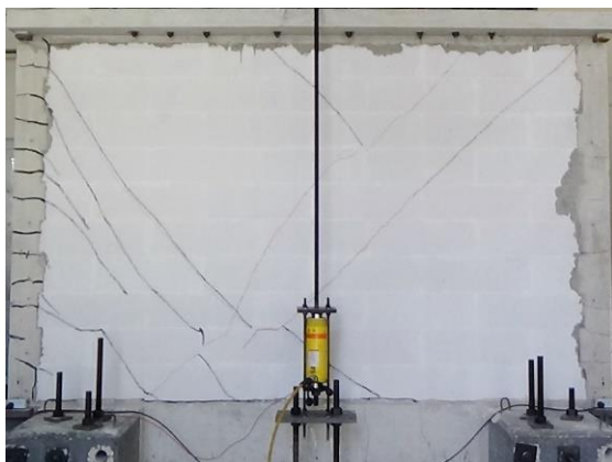
Figura 4.5 Agrietamiento diagonal por cortante del muro M-0.71-3.0.
