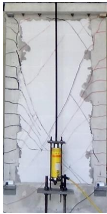
Figura 4.22 Grietas por flexión, flexo-cortante y diagonales por cortante a la carga máxima del muro M-1.94-3.0.
