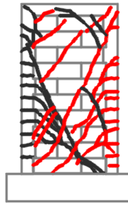
Figura 4.22 Grietas por flexión, flexo-cortante y diagonales por cortante a la carga máxima del muro M-1.94-3.0.
