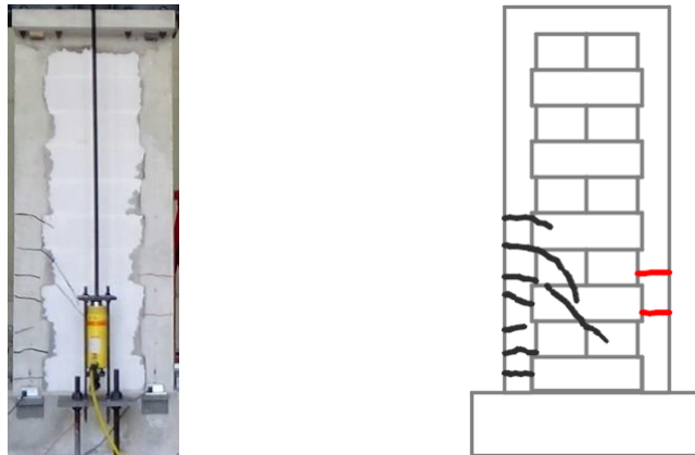
Figura 4.28 Agrietamiento por flexo-cortante del muro M-2.64-3.0.
