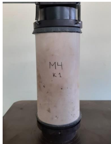
Figura 3.3 Ensayo a compresión de un cilindro de concreto.
