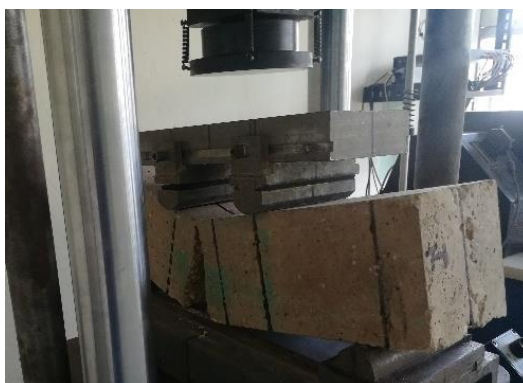
Figura 4.3. Falla observada en las vigas de concreto.
