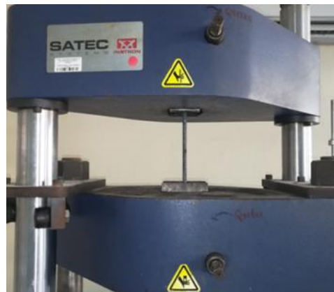
Figura 3.5. Ensaye a tensión axial de una barra de acero de refuerzo.
