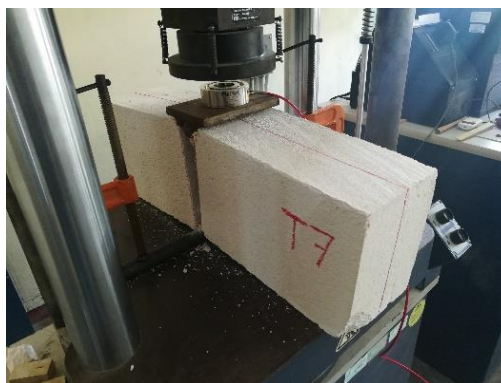
Figura 4.2. Falla observada en los bloques de CCA.
