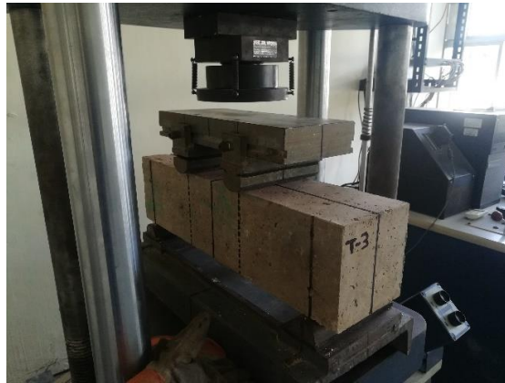
Figura 3.4. Ensaye a tensión por flexión de vigas de concreto.
