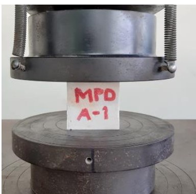
Figura 3.7. Ensaye a compresión de un cubo de mortero de pared delgada.
