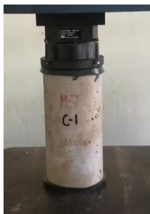
Figura 3.3. Ensaye a compresión de un cilindro de concreto.
