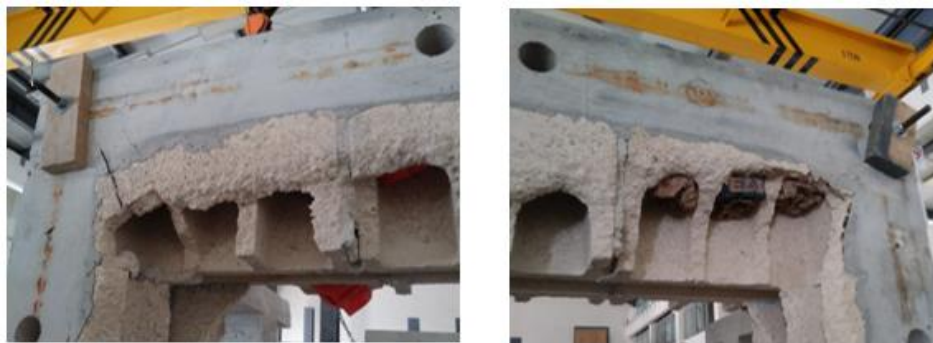
Figura 3.2 Aplastamiento del panel en las zonas rígidas del marco de EC
