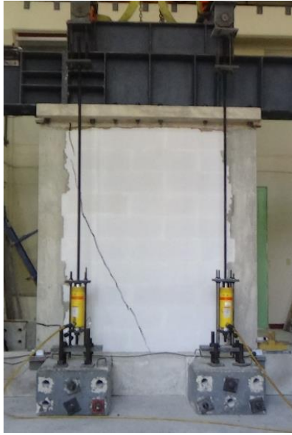
Figura 4.11 Formación de primer agrietamiento del muro M-1.23-7.2
