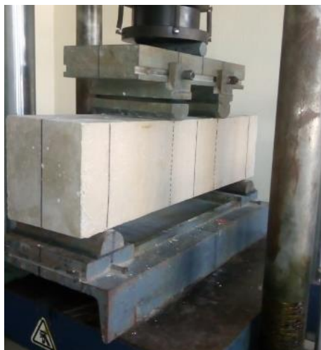
Figura 3.5 Ensayo a tensión por flexión de una viga de concreto
