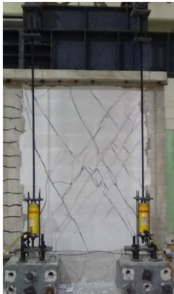
Figura 4.14 Patrón de agrietamiento final del muro M-1.23-7.2
