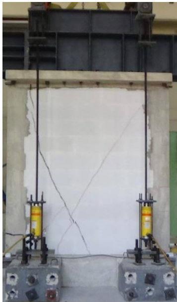
Figura 4.12 Primer agrietamiento por cortante sentido negativo del muro M-1.23-7.2
