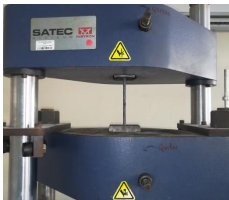
Figura 3.4 Ensayo a la fluencia a una barra de acero
