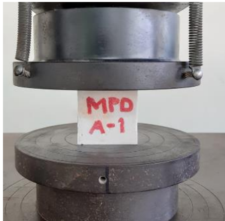
Figura 3.7 Ensaye a compresión de un cubo de pared delgada
