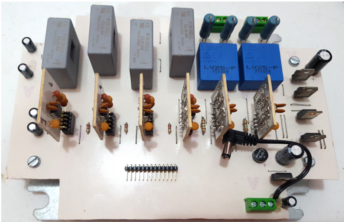
Figura 20 Tarjeta de medición de potencia ya manufacturada (de la Cruz May 2018).
