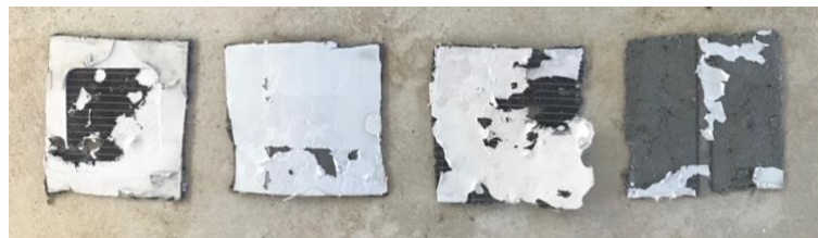
Figura 27. Evolución de las muestras desbastadas hasta únicamente dejar la celda con el EVA (derecha).
