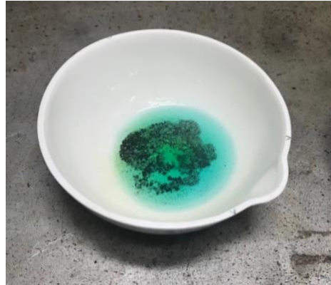
Figura 18. Digestión en proceso después de verter 5 ml de ácido nítrico y 0.5 ml de ácido fluorhídrico.
