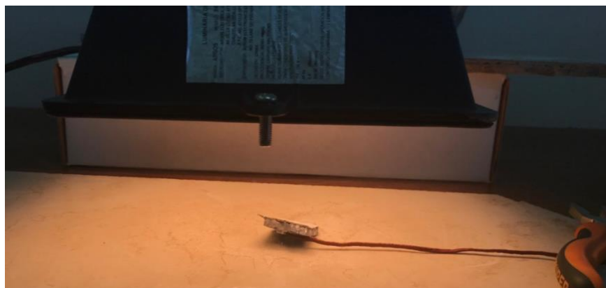
Figura 22. Termopar colocado en la muestra para medir temperatura del vidrio a lo largo del tiempo.
