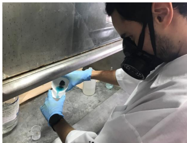
Figura 19. Filtrado del producto resultante de la digestión
