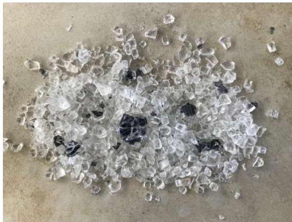
Figura 14. Pedazos de vidrio con celda adherido posterior a la separación
