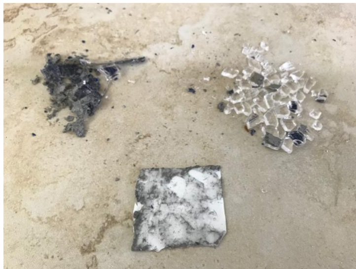
Figura 26. Separación de vidrio, backsheet y celda solar por medio de calentamiento y utilizando un cúter.
