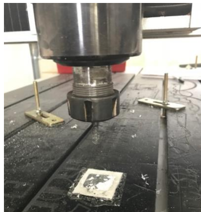
Figura 16. Fresadora CNC desbastando la capa de backsheet de una muestra.
