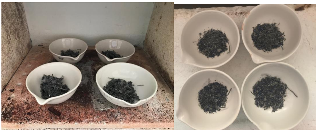
Figura 17. Antes (izquierda) y después (derecha) de colocar las muestras en la mufla. El EVA se evapora por completo dejando únicamente los metales.
