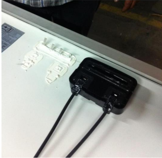
Figura 9. Caja de conexiones ya despegada
