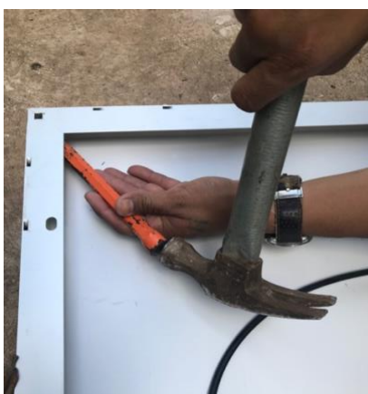
Figura 8. Colocación de martillo y cinzel en panel solar para separar el marco
