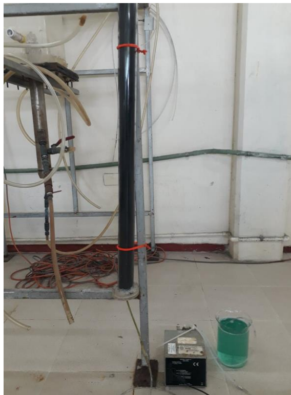
Figura 11 Reactor tipo columna de adsorción de flujo ascendente, empacado con carbón activado modificado.
