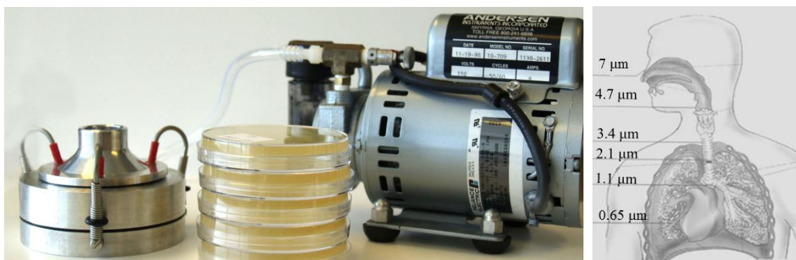
Figura 3. Sistema Andersen de dos etapas y relación del tamaño de partícula con la captación en el sistema respiratorio.
