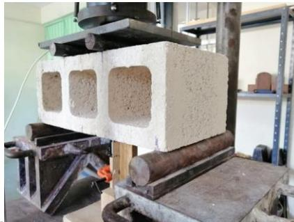
Figura 3.11 Ensayo a flexión de bloques huecos de concreto de 3 celdas.
