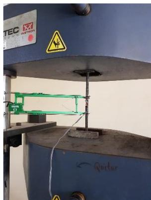
Figura 3.5 Ensayo a tensión de una varilla de acero
