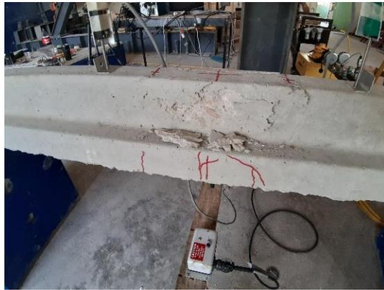
Figura 4.10 Inicio del aplastamiento del concreto
