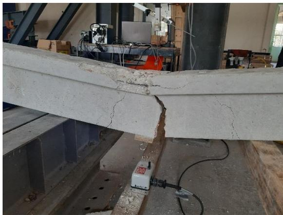
Figura 4.13 Fractura del acero en viga invertida
