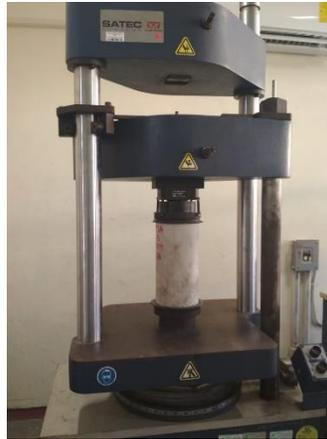
Figura 3.1 Ensayo a compresión en máquina universal de 60 ton
