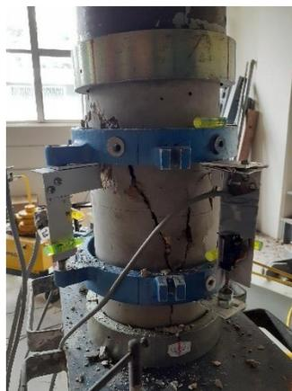
Figura 3.3 Ensayo a compresión de un cilindro de concreto para determinar módulo de elasticidad.
