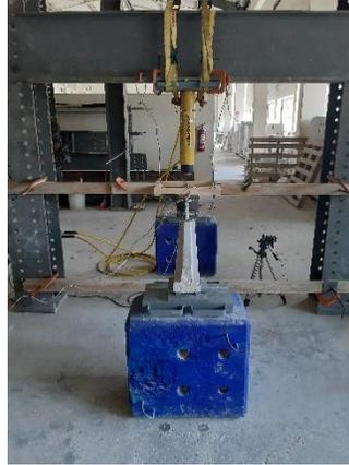
Figura 3.8 Vigueta colocada e instrumentada para el ensaye
