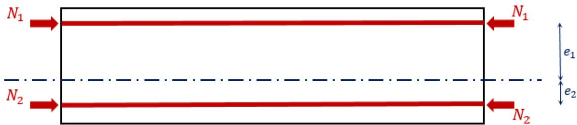
Figura 2.3 Fuerzas axiales en el concreto en cada lecho de acero.
