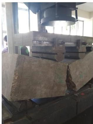
Figura 3.4 Ensayo a tensión por flexión de una viga de concreto
