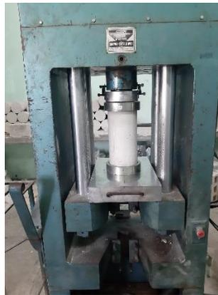
Figura 3.2 Ensayo a compresión en máquina universal de 180 ton
