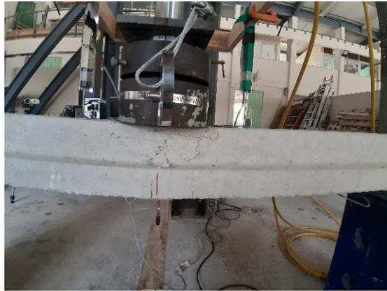
Figura 4.9 Aparición de grietas de flexión
