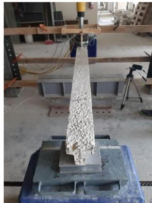
Figura 3.10 Vigueta en posición invertida
