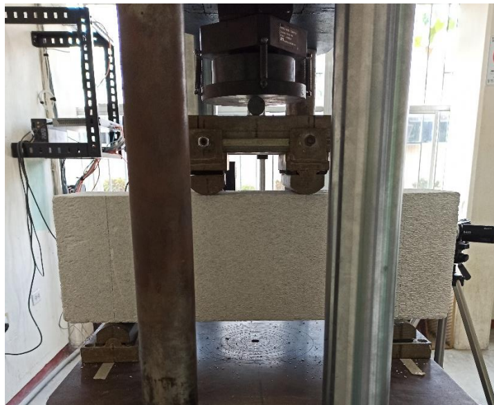
Figura 3.7 Ensaye a tensión por flexión de bloques de CCA.
