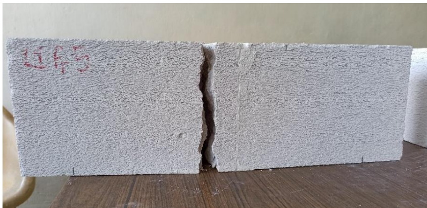
Figura 4.3 Falla típica de espécimen ( f_{rCCA-adh} ).
