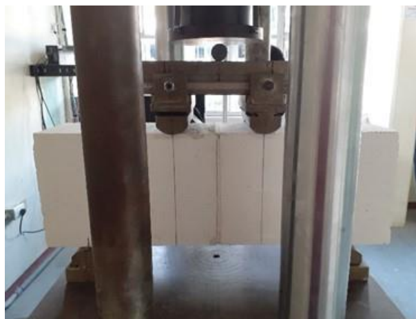
Figura 3.10 Ensayo a tensión por flexión con junta de mortero.
