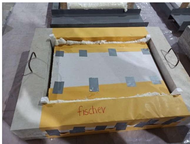
Figura 3.13 Junta de espuma de poliuretano.
