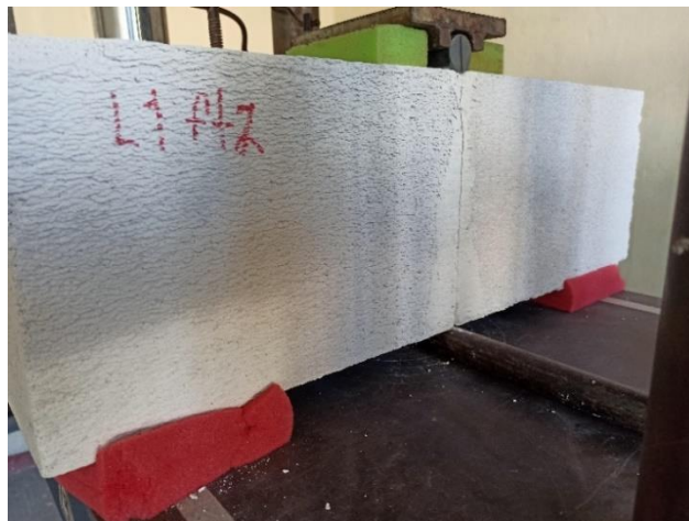
Figura 3.9 Ensayo a tensión por compresión con junta de mortero de pared delgada.
