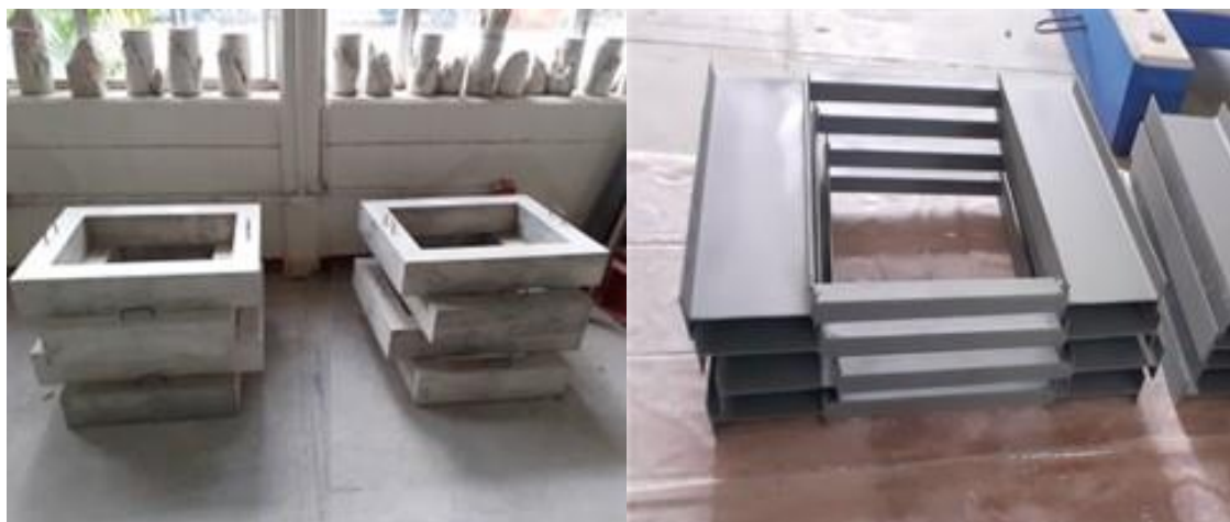
Figura 7.12 Marcos de concreto y acero.
