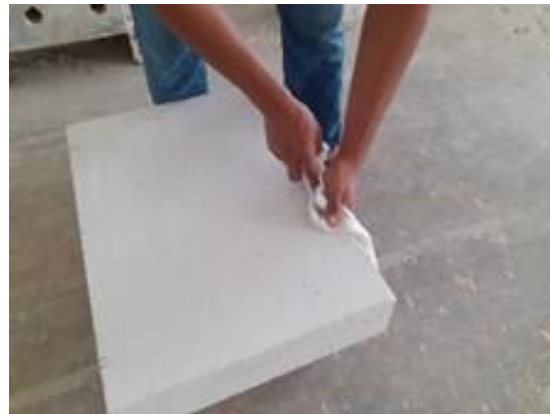
b) Limpieza de la pieza de CCA.
