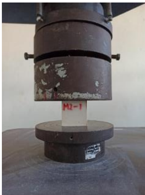
Figura 3.11 Ensaye a compresión de cubos de mortero de pared delgada.
