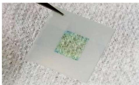
Figura 4.3. Película de ZnO depositada por RFMS.
