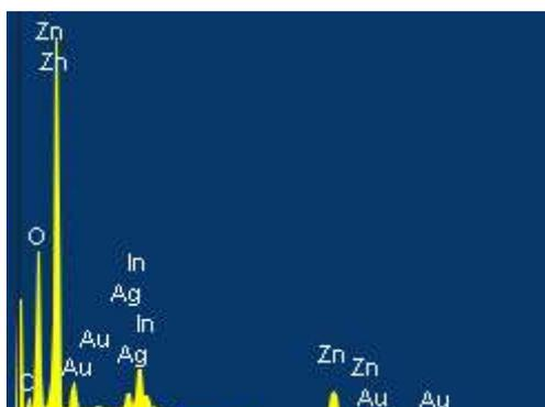
Figura 2.6. Imagen obtenida por espectroscopía de energía dispersa de rayos X.
