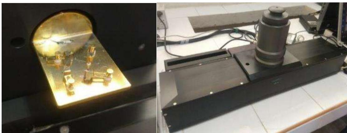
Figura 4.30. Mediciones eléctricas por efecto Hall para la muestra de  $\text{In}_3\text{O}_2$ /Au/Ag.
