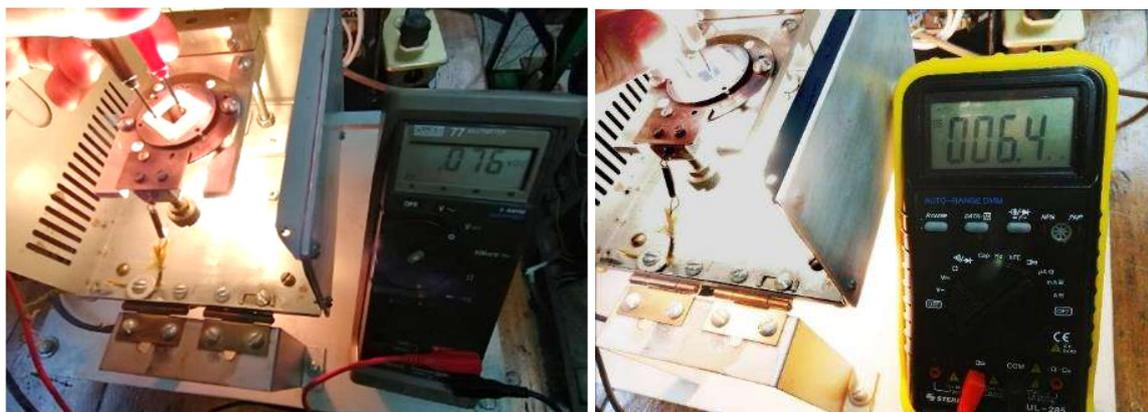
Figura 4.37. Medición del voltaje y amperaje bajo iluminación de las celdas solares elaboradas.
