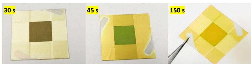
Figura 4.5. Películas de CdS depositadas por RFMS.
