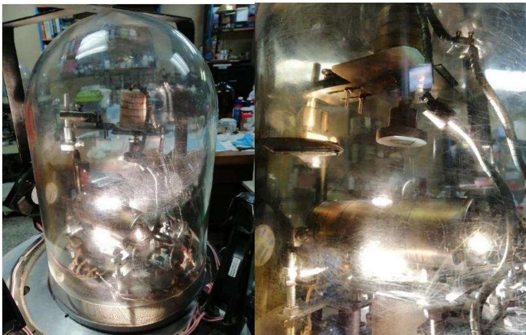
Figura 3.6. Crecimiento de CdTe por evaporación térmica.
