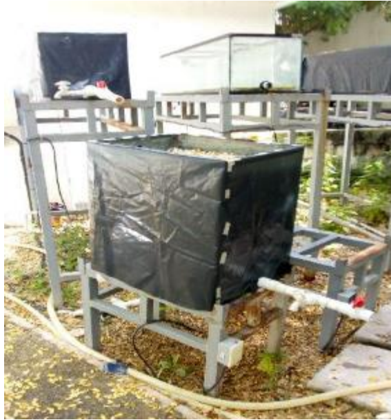
Figura 8. Alimentación de los humedales por medio de gravedad debido a la diferencia en alturas.
