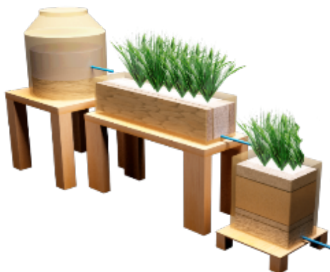
Figura 12. Configuración del sistema de humedales artificiales híbridos para su operación en serie.
