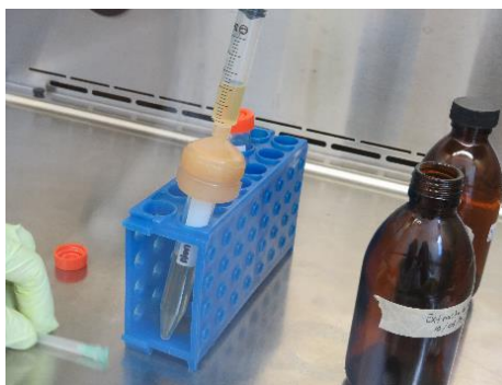
Figura 3. Filtración de los extractos de ajo y noni
