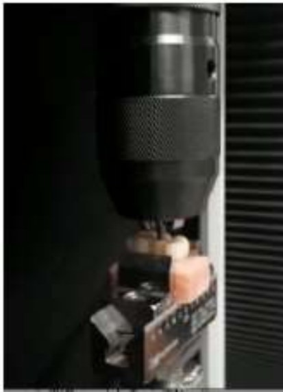
Fig. 9. Máquina de ensayo universal INSTRON.
