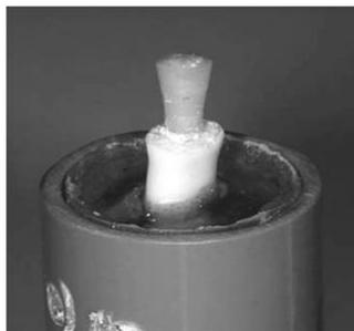
Figura 3. Ejemplo de una muestra preparada para un ensayo de *pull-out* (37).
