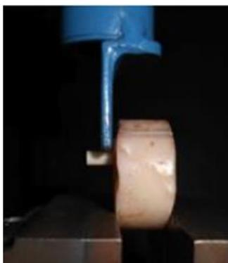
Figura 1. Ejemplo de un montaje para prueba en cortante (cizalla) (31).
