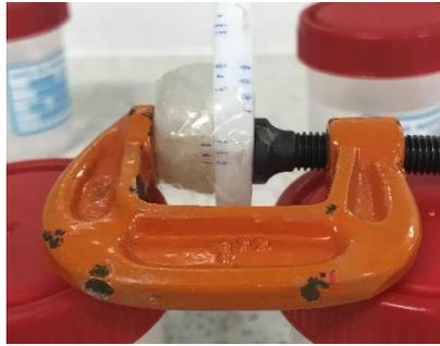
Figura 7. Muestra montada en la prensa durante su fraguado.
