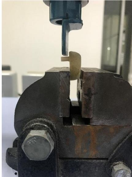
Figura 9. Muestra montada para ensayos en cortante empleando una máquina de ensayos mecánicos Mini Shimadzu.
