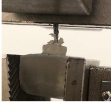
Figura 15. Falla cohesiva del grupo SP (control). El cilindro de CIV se fracturó en todas las muestras del grupo.
